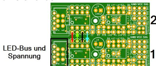
2. Der LED-Bus muss an der untersten Platine (im Bild Platine Nummer Eins) angeschlossen werden.
