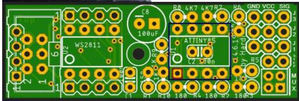
Nun folgt, wenn man sich für die DIP-Variante entschieden hat, das einlöten von dem 8-Pin-Sockel für U2. Die Markierung am Sockel/IC ist auf dem Bild wieder hervorgehoben. Sollte man sich für die SMD-Variante entschieden haben, bleibt der Sockel leer. U3 wird auf der Unterseite der Platine aufgelötet. Dieser Vorgang wird [hier](#) weiter unten beschrieben.
