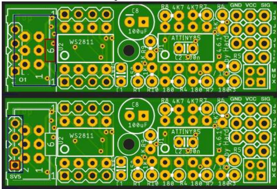
Das letzte Bauteil das noch fehlt ist der Elektrolytkondensator C8.
