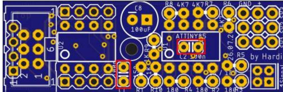
Als nächstes kommt der Sockel für U1 an die Reihe. Dieser wird über den Kondensator C2 gesteckt, sowie auf dem Bild zu sehen ist. Die Markierung am Sockel/IC ist auf dem Bild hervorgehoben.
