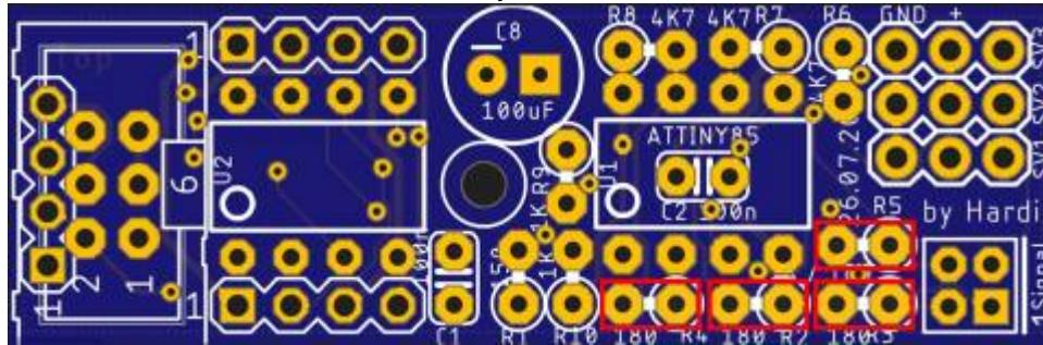
Für den Ausgang der Moduls wird eine 2x2-polige Stifteleiste mit einem Rastermaß von 2.00 mm verwendet. Die passenden Stecker sind z.B.: [hier bei "Distrelec" erhältlich](#).
