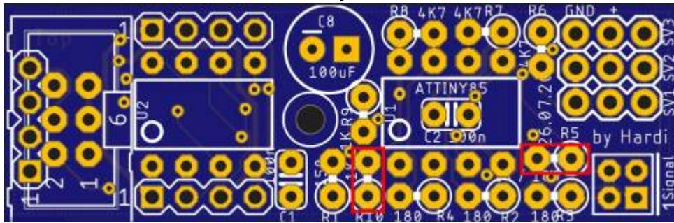
Die Anschlüsse für die drei Ausgänge J1 - J3 kommen als nächstes dran. Die Beschriftung auf der Platine ist leider fehlerhaft. Auf dem Bild ist die richtige Beschriftung der Pins erkennbar.
