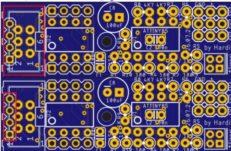
Das letzte Bauteil das noch fehlt ist der Elektrolytkondensator C8.
