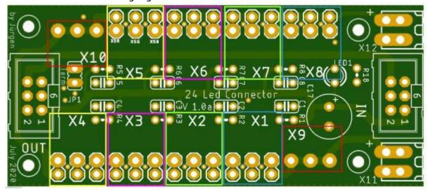
Das letzte Bauteil das noch fehlt ist der Elektrolytkondensator C17. Bei diesem bitte auf die Polung achten. Der Pluspol ist auf der Platine markiert.
