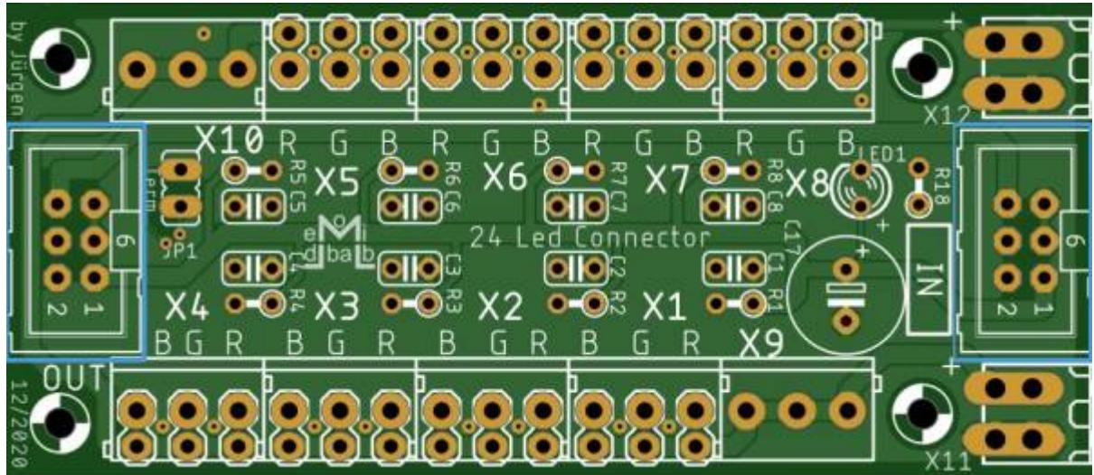
sowie die Stifteleisten für die optionale Spannungsversorgung X11 und X12
