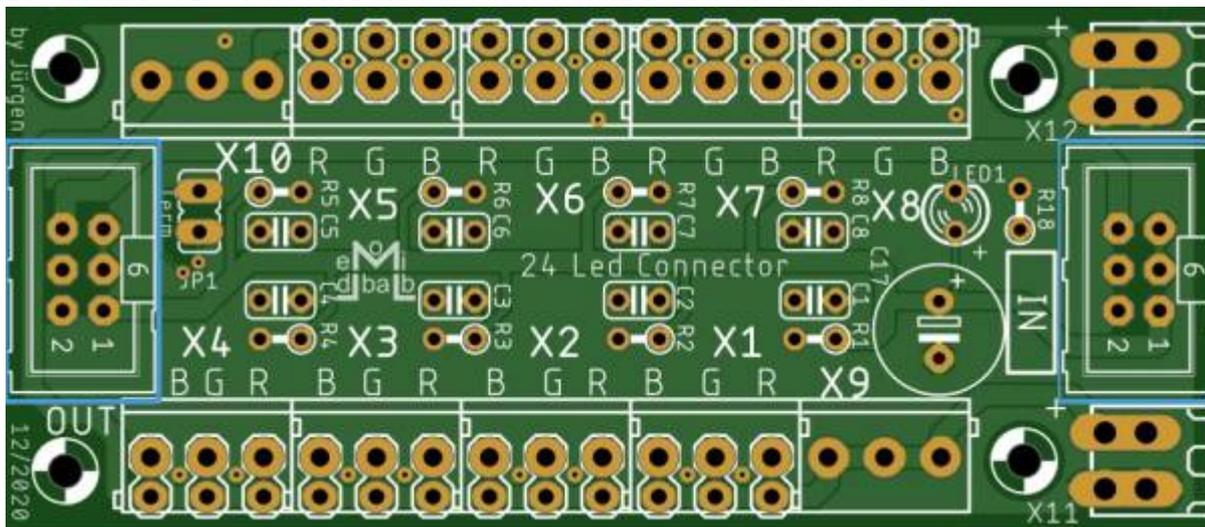
sowie die Stiftleisten für die optionale Spannungsversorgung X11 und X12
