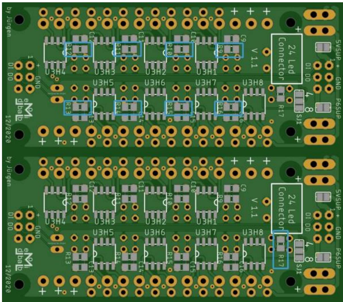
Auf der Unterseite werden nun noch die 8 WS2811 eingelötet. Dabei unbedingt auf die Einbaurichtung achten. Die Markierung am IC und auf der Platine ist hervorgehoben.
