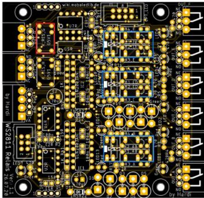
Da die beiden Elektrolytkondensator C1 & C2, mit  $470\mu\text{F}$ , die höchsten Bauteile sind, folgen diese zum Schluss auf der Oberseite.
