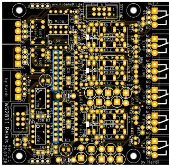
Im Anschluss folgen die drei Widerstände R1, R2 und R3 mit 150 Ohm, sowie die 7 Widerstände mit 470 Ohm für die LEDs.
