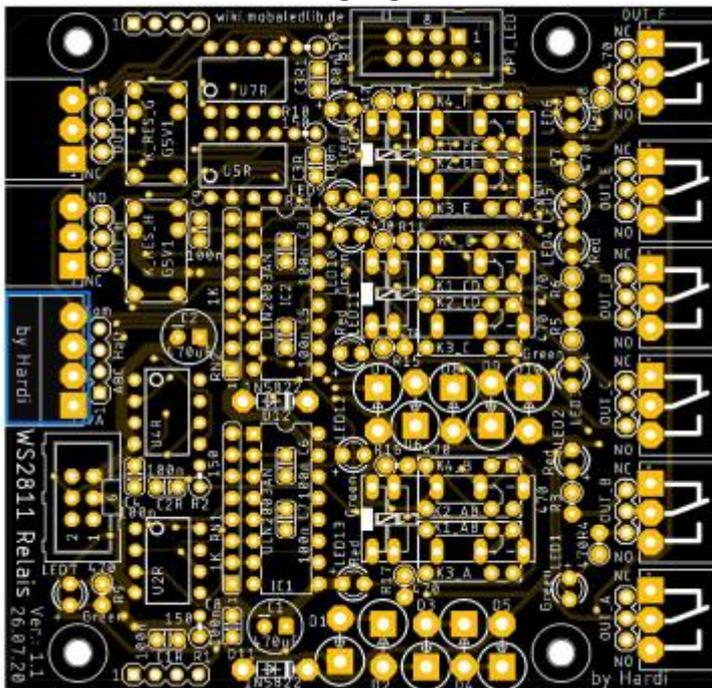
und die 10 Gleichrichterdioden D1 - D10 (blau), sowie die Schottkydioden D11 und D12 (rot). Bei den Dioden unbedingt auf die Polarität achten. Der Ring der Diode muss jeweils beim großen Ring auf der Platine sein bzw mit dem Ring übereinstimmen.
