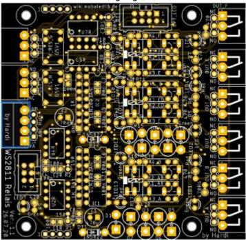
und die 10 Gleichrichterdioden D1 - D10 (blau), sowie die Schottkydioden D11 und D12 (rot). Bei den Dioden unbedingt auf die Polarität achten.
