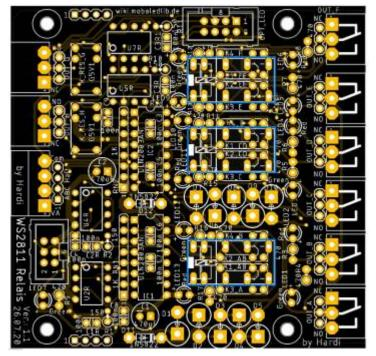
Da die beiden Elektrolytkondensator C1 & C2, mit  $470\mu F$ , die höchsten Bauteile sind, folgen diese zum Schluss auf der Oberseite.
