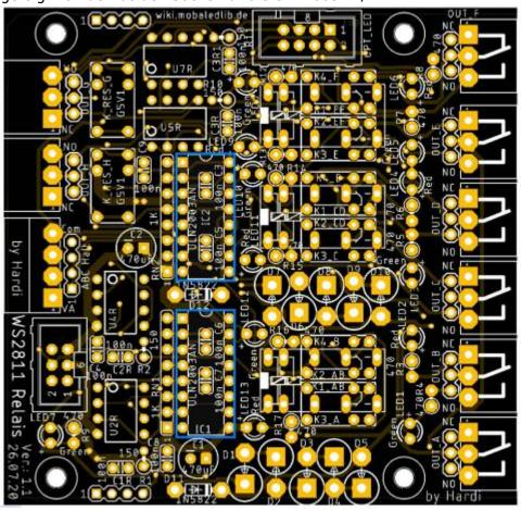
sowie die beiden Widerstandsnetzwerke RN1 und RN2. Bei diesen bitte auf die Markierung am Gehäuse achten. Meistens ist die ein Punkt, dieser muss in Pin1 der Lötstelle (rechteckiges Lötpad)
