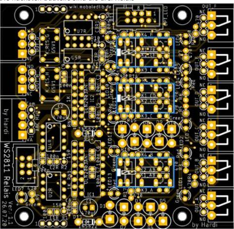
Da die beiden Elektrolytkondensator C1 & C2, mit 470µF, die höchsten Bauteile sind, folgen diese zum Schluss auf der Oberseite.
