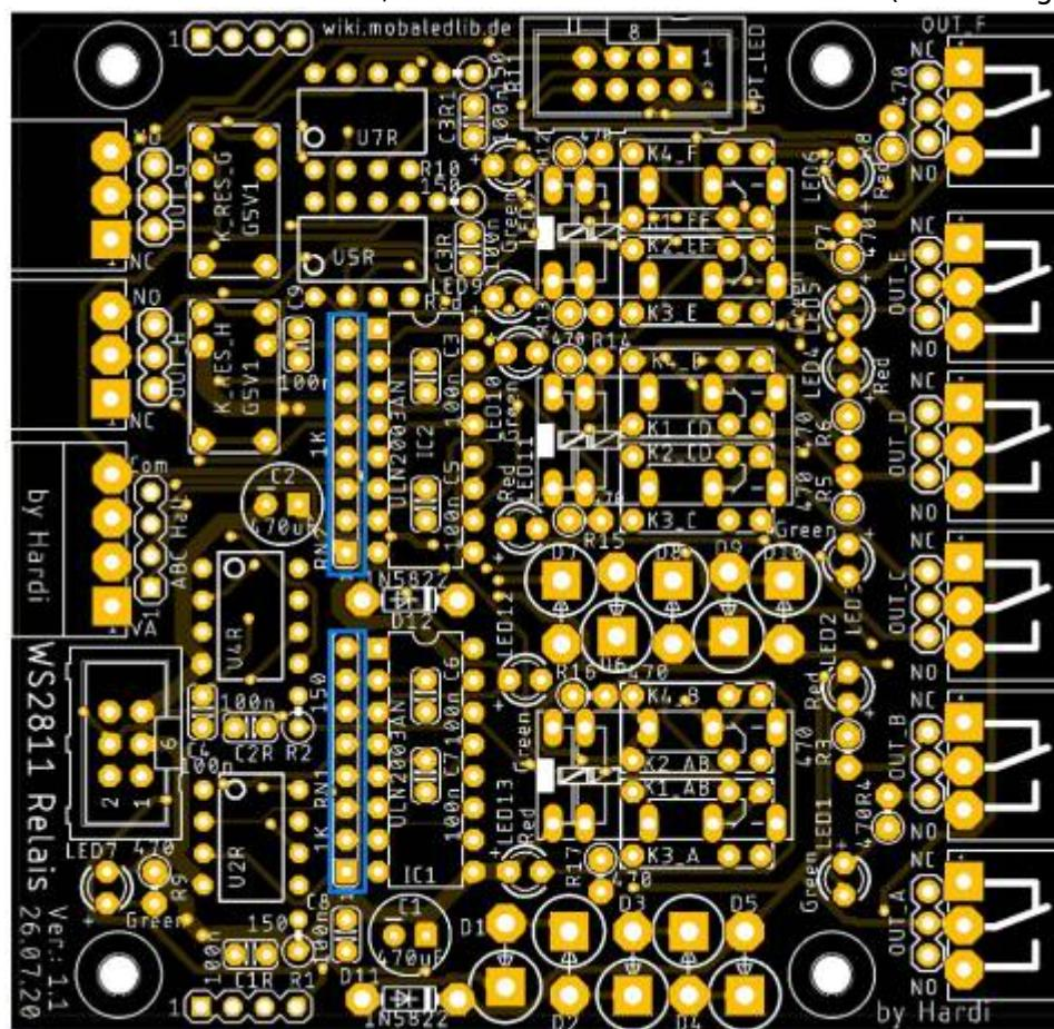
Im Anschluss folgen die beiden Widerstände R1 und R2 mit 150 Ohm, sowie die 7 Widerstände mit 470 Ohm für die LEDs.
