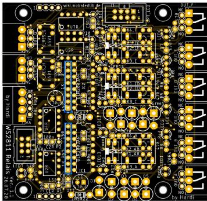
Im Anschluss folgen die beiden Widerstände R1 und R2 mit 150 Ohm, sowie die 7 Widerstände mit 470 Ohm für die LEDs.
