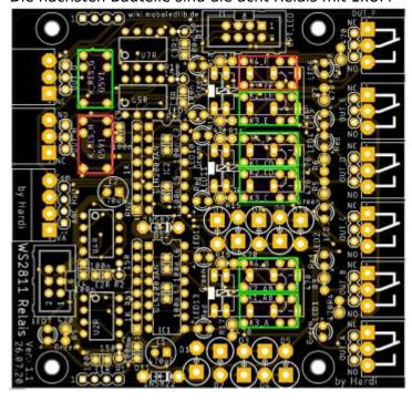
Da die beiden Elektrolytkondensator C1 & C2, mit  $470\mu F$ , die höchsten Bauteile sind, folgen diese zum Schluss auf der Oberseite.
