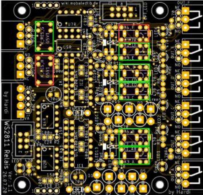
Da die beiden Elektrolytkondensator C1 & C2, mit 470µF, die höchsten Bauteile sind, folgen diese zum Schluss auf der Oberseite.
