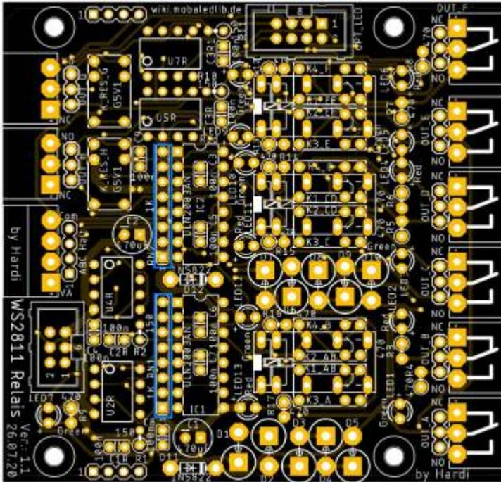
Im Anschluss folgen die drei Widerstände R1, R2 und R3 mit 150 Ohm, sowie die 7 Widerstände mit 470 Ohm für die LEDs.
