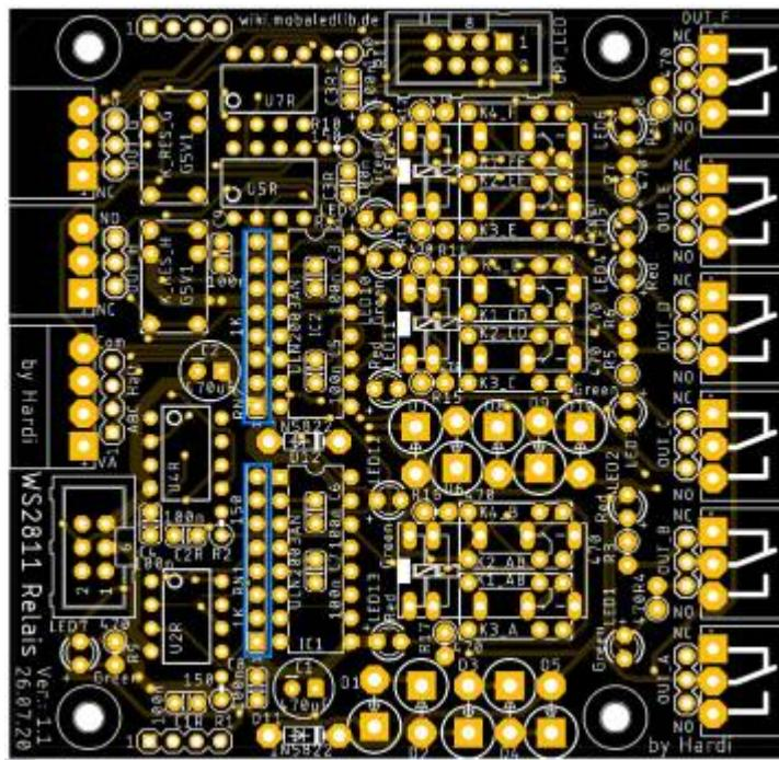
Im Anschluss folgen die drei Widerstände R1, R2 und R10 mit 150 Ohm, sowie die 7 Widerstände R9, R12 - R17 mit 470 Ohm für die LEDs.
