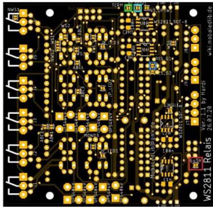
Der Jumper „6=5V“ (rot) kann geschlossen werden, wenn an dem Pin6 des Wannensteckers zusätzliche 5V zur Verfügung stehen zur Versorgung der Platine.
