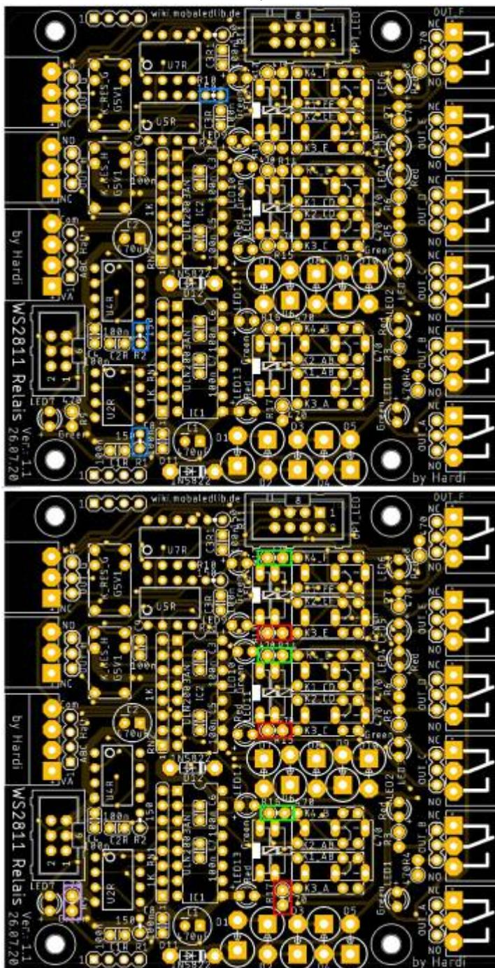
Als nächstes kommt die gelbe LED (LED7) für die Anzeige der Spannungsversorgung und die jeweils drei grünen und roten LEDs (LED8 - LED13) für die Anzeige der Relaisansteuerung. Die Pluspole sind dabei jeweils auf der linken Seite oder unten.
