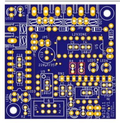
Wer die Dioden D5, D6, D7 und D8 nicht bei den Weichen platzieren möchte, darf nun diese einlöten.
