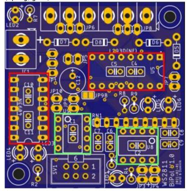
sowie das Widerstandsnetzwerk RN1, Sollte Pin1 nicht markiert sein, bitte durchmessen. Pin 1 ist die Seite, wo nur ein Widerstand von ca.  $1 \text{K}\Omega$  gemessen wird. weitere Infos dazu im Forum
