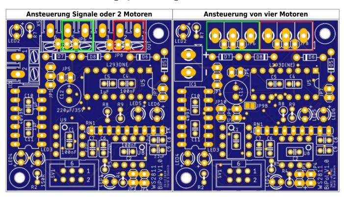
sowie der Elektrolytkondensator C12 (220µF / 35V)
