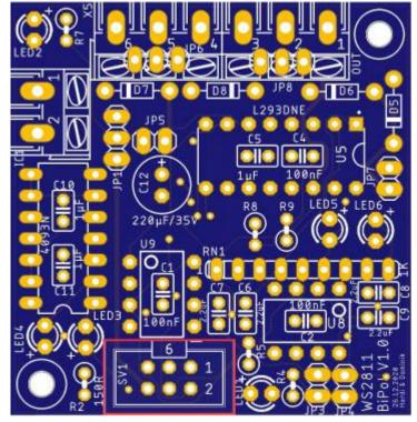
die 2polige Schraubklemme für Power-IN (VCC und GND ist markiert),
