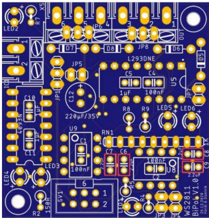
Als nächstes kommen die beiden IC-Sockel für IC1 (14polig, rot) und U5 (16polig, rot), sowie wenn die Verwendung der DIP-Version vorgesehen ist, die beiden Sockel für die WS2811 (8polig, grün).
