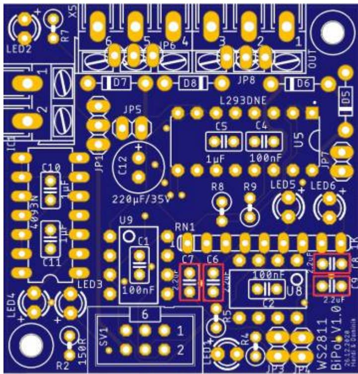
Als nächstes kommen die beiden IC-Sockel für IC1 (**Bei der Platinenversion vom 26.12.2020 nur 13polig, da Pin10 entfernt werden muss.**) und U5 (16polig)
