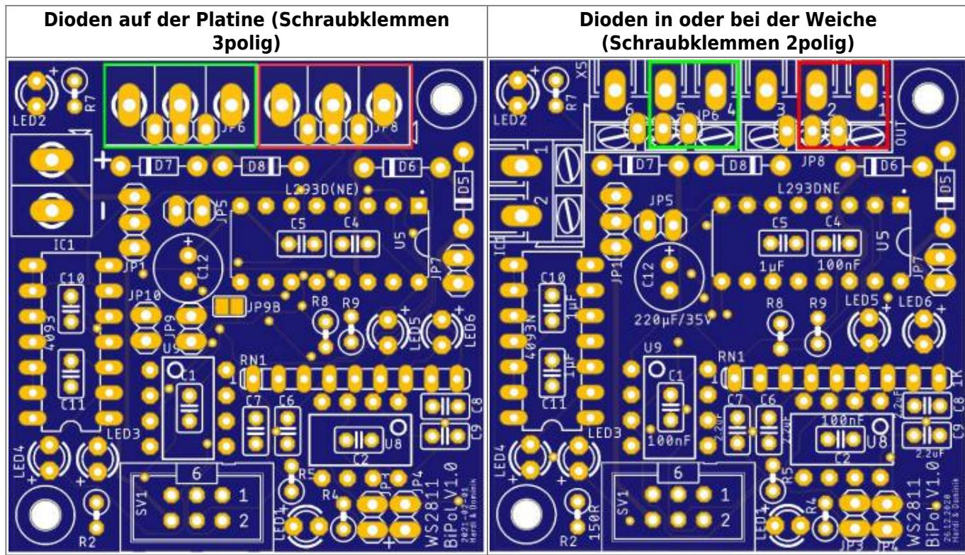
sowie der Elektrolytkondensator C12 (220 $\mu$ F / 35V)
