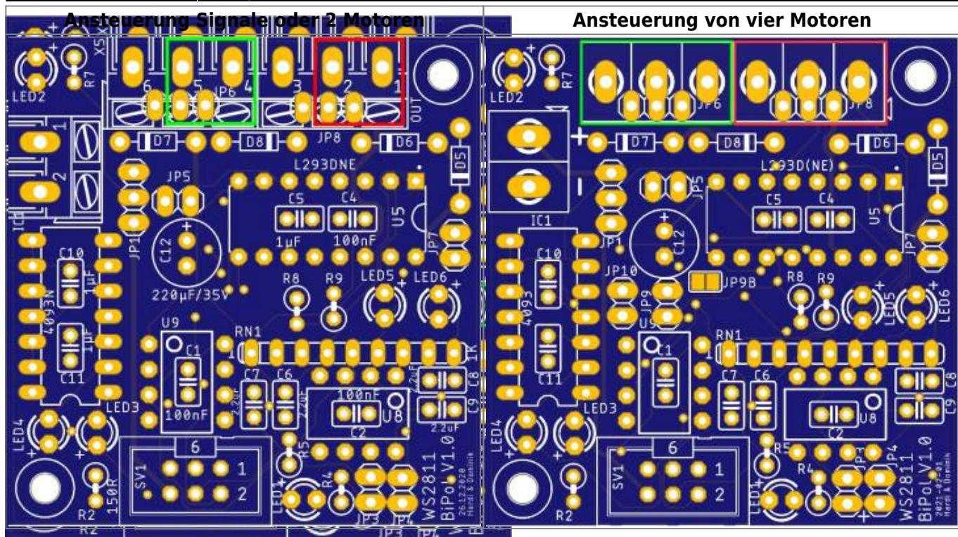
sowie der Elektrolytkondensator C12 (220µF / 35V) an der Wabenstecker SV1,
