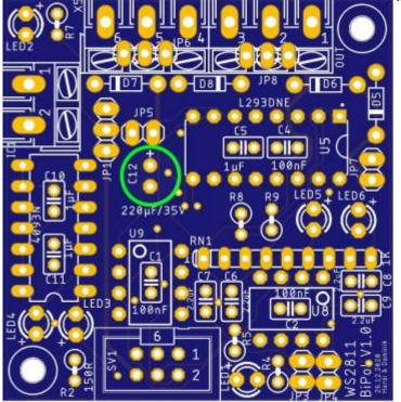
die 2polige Schraubklemme für Power-IN (VCC und GND ist markiert), **Untersette Achtung: Bei der Version vom 01.02.2021 wurde die Position von VCC und GND verändert.**
