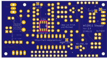
Wer den IC in der DIP-Version verwendet, hier muss zusätzlich zum IC auch ein IC-Sockel verbaut werden.
