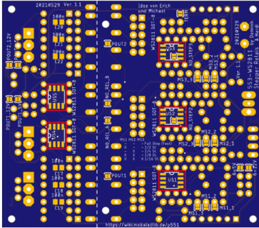
bei Bedarf Anti-Pfeiff-Keramikkondensatoren. C17, C18, C19, C20, C21, C22
