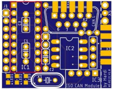
Danach folgt die Fassung für IC2. Hier bitte keine Präzisionsfassung verwenden, dann ist es nämlich möglich durch das Geradebiegen der Beinchen den IC in einem Sockel einzustecken.
