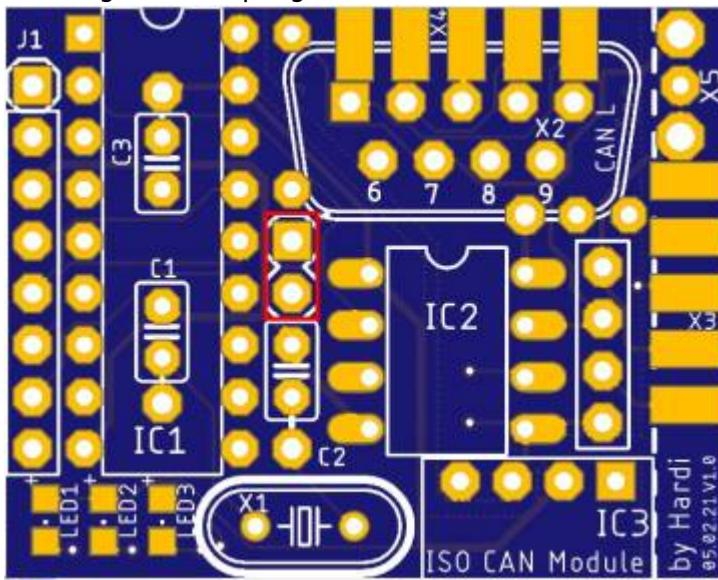
Als nächstes folgt der CAN-Bus-Anschlüsse X3. Als erstes werden auf der Ober- und UNterseite die Lötflächen **dünn** vorverzinnt. Anschließend die Stecker probeweise einmal an die vorgesehene Stelle halten. Sollte der Abstand zu groß sein, kann man die Lötkelche vorsichtig zusammen drücken. Danach werden die SUB-D-Stecker zuerst auf der Platinenoberseite verlötet und im Anschluss wird die gesamte Platine gewendet und auf der Unterseite verlötet.
