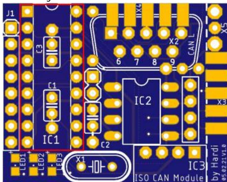
Danach folgt die Fassung für IC2. Hier bitte keine Präzisionsfassung verwenden, dann ist es nämlich möglich durch das Geradebiegen der Beinchen den IC in einem Sockel einzustecken.
