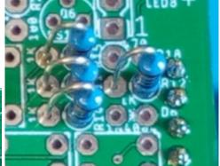
Nun folgen die 6 farbigen LEDs LED1 - LED6. Diese werden entweder vorsichtig bis zum Anschlag in die Platine eingesteckt und anschließend verlötet oder mit Hilfe des 3D-Abstandhalters eingelötet.
