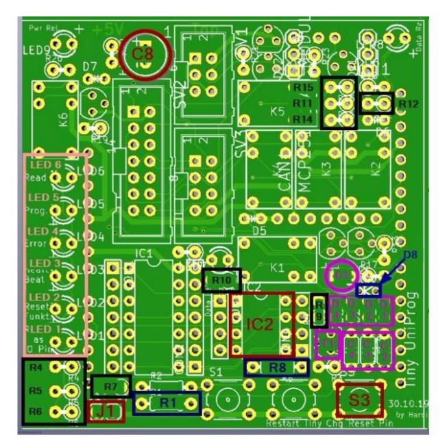
Den Anfang machen die Widerstände R1 und R8, da diese liegend eingebaut werden, gefolgt von dem IC-Sockel IC2 und dem Taster S3.
