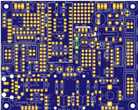
gefolgt von den Dioden D3, D4 und D5 (1N4148)
