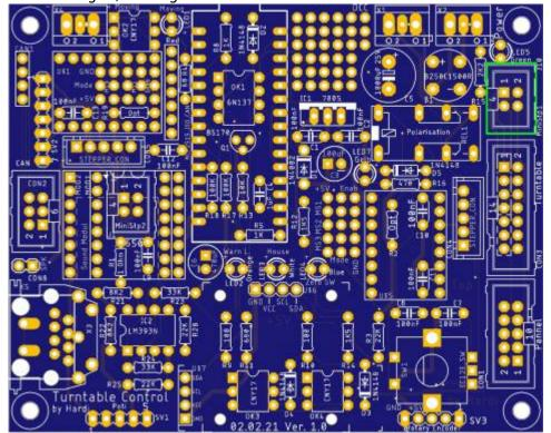
sowie der 10-polige Wannenstecker (CON1) für den externen Anschluss des Bedienpanels (OLED, Poti und Encoder).
