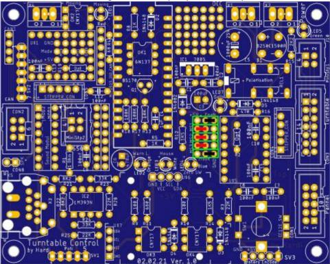
Die Standard-Einstellung für die fünf Jumper für das zusätzliche Steppermodul ist nachfolgend abgebildet.
