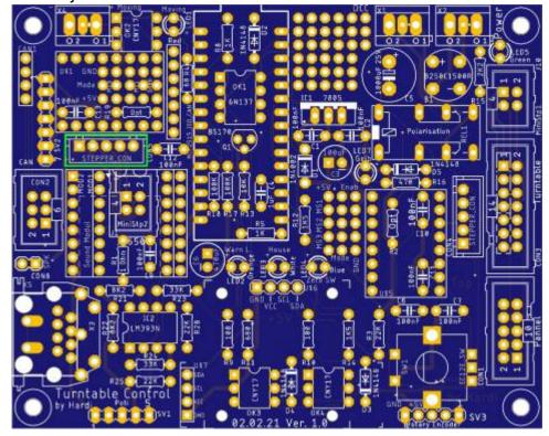
Den Abschluss bilden die beiden 8-poligen Buchsenleisten für das Steppermodul.
