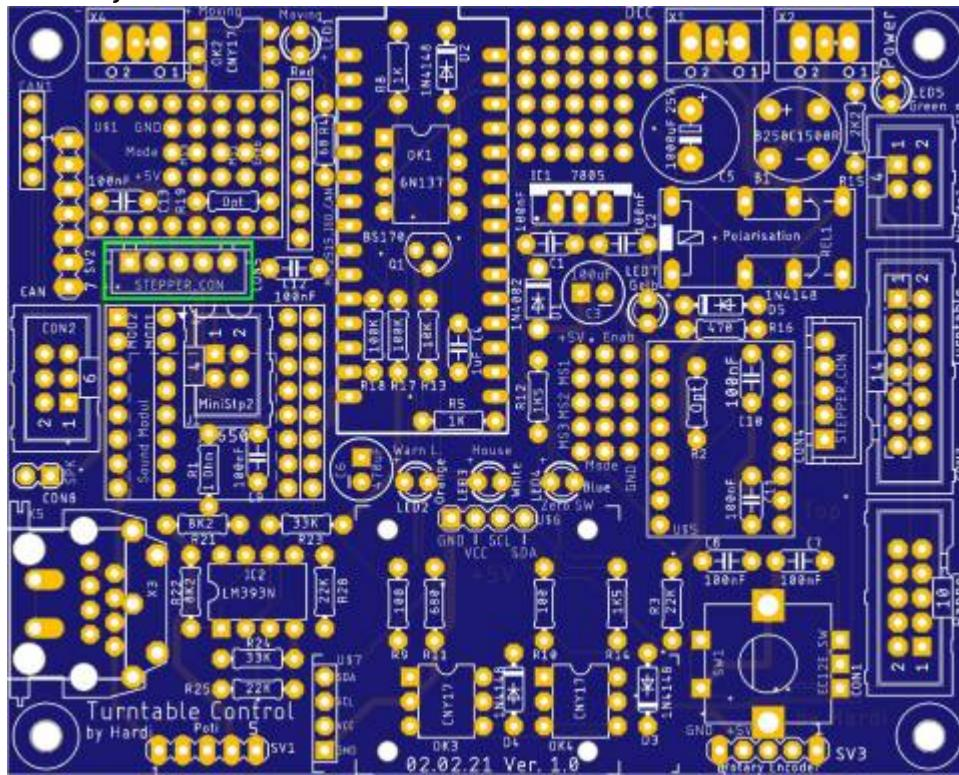
Den Abschluss bilden die beiden 8-poligen Buchsenleisten für das Steppermodul.
