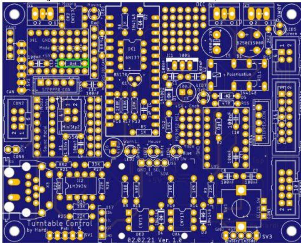
gefolgt von den beiden Kondensatoren C12 & C13 (100nF).
