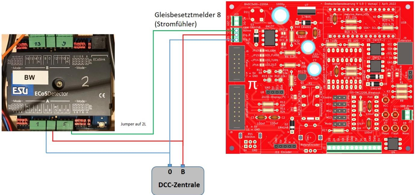
Bei **3-Leiter-Anlagen** kann man die Bühnengleise direkt an die Zentrale anschließen und ggf. einen Gleisbesetzmelder dazwischen schalten. Die Bühnenspannung muss nicht über die Hauptplatine geführt werden (es wird ja auch kein Umpolarisierungsrelais benötigt).
