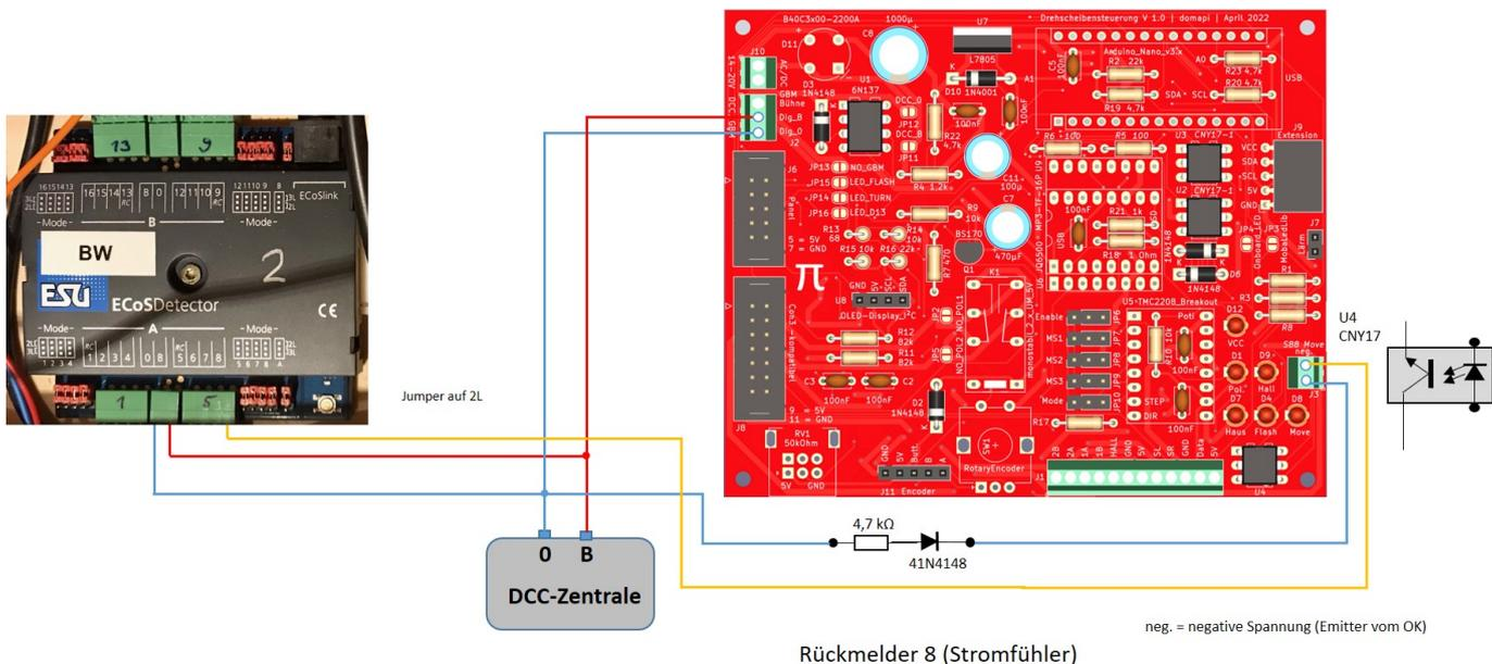
Der Strom fließt dann von Digital B (rotes Kabel) durch den Gleisbesetzmelder zum Emitter des Optokopplers (orangenes Kabel). Wenn der durchschaltet weiter zur Diode und dem Widerstand zum Digital 0 Anschluss der Zentrale.
