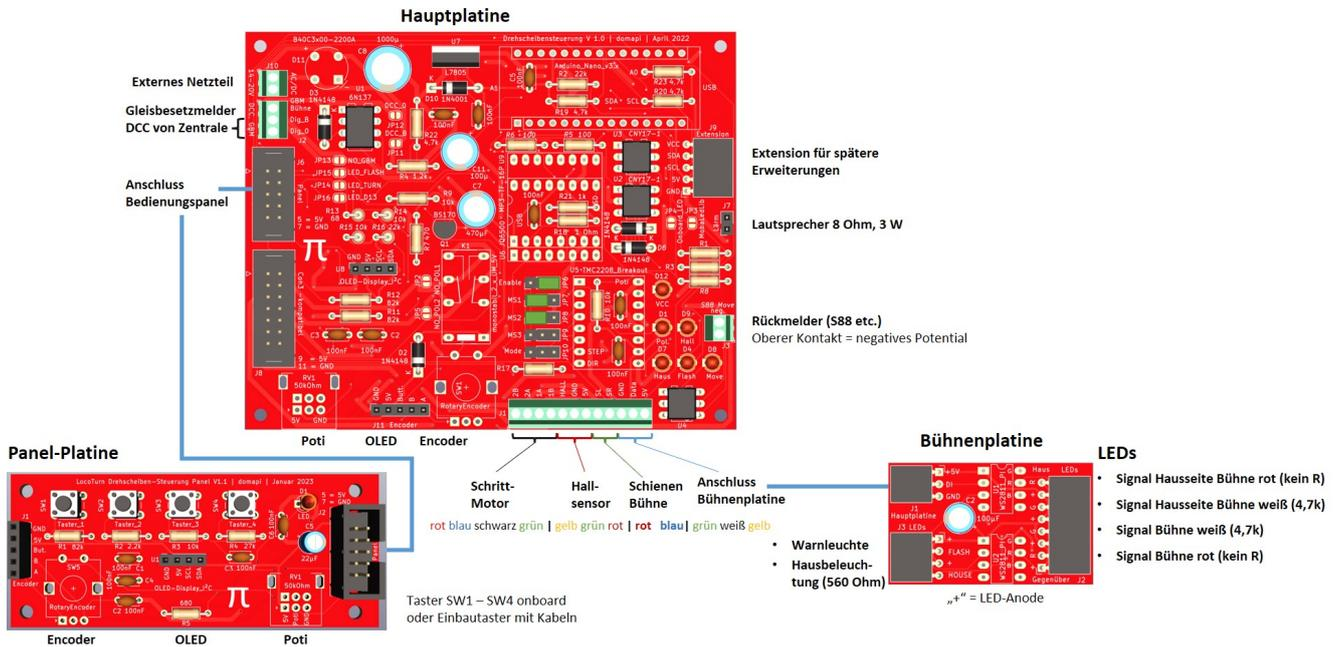
Die bisher getesteten Schritt-Motore haben mit ihren vier Anschlusskabeln für ihre 2 Motor-Spulen alle zum Farbschema rot-blau-schwarz-grün in der Abbildung gepasst. Damit dreht die Bühne beim Kalibrieren im Uhrzeigersinn.
