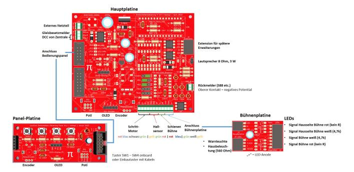
Die bisher getesteten Schritt-Motore haben mit ihren vier Anschlusskabeln für ihre 2 Motor-Spulen alle zum Farbschema rot-blau-schwarz-grün in der Abbildung gepasst. Damit dreht die Bühne beim Kalibrieren im Uhrzeigersinn.
