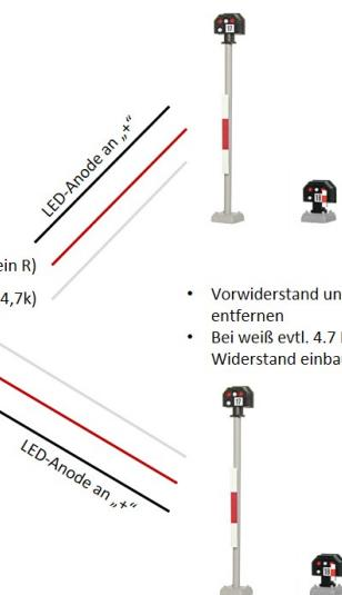
So werden die Signale auf der Bühne verbaut (auf dem Hausdach befindet sich eine orangene LED als Warnleuchte und unter dem Hausdach wurde eine weiße LED für die Innenbeleuchtung montiert):
