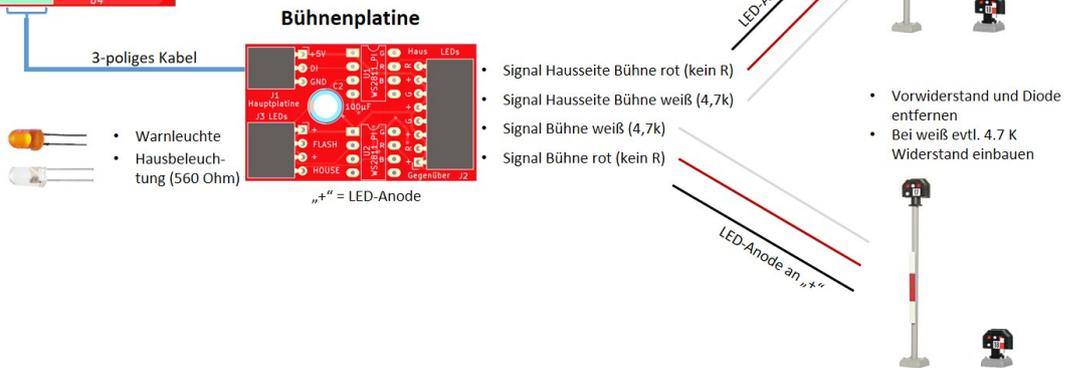
So werden die Signale auf der Bühne verbaut (auf dem Hausdach befindet sich eine orangene LED als Warnleuchte und unter dem Hausdach wurde eine weiße LED für die Innenbeleuchtung montiert):
