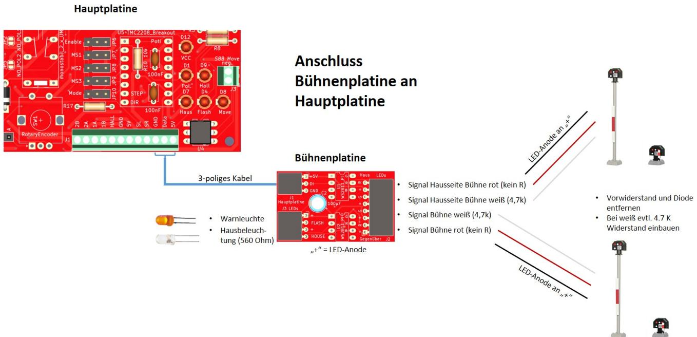
So werden die Signale auf der Bühne verbaut (auf dem Hausdach befindet sich eine orangene LED als Warnleuchte und unter dem Hausdach wurde eine weiße LED für die Innenbeleuchtung montiert):
