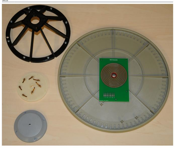
Das weiße Teil mit den Schleifern (mitte links) stammt von der Original-Drehscheibe.
