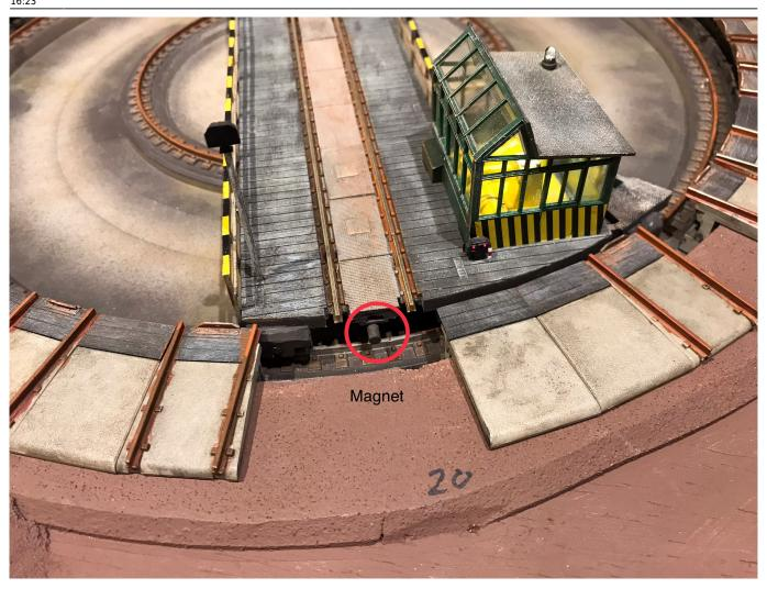
Der Magnet wird unter der Bühne festgeklebt; Höhe, Abstand und die Magnet-Richtung vorher ausprobieren, damit der Hallsensor zuverlässig auslöst.
