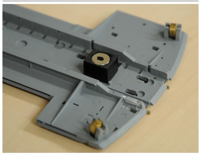
In die runde graue Abdeckung für die Schleifer wurde die Messing-Achse für den Schrittmotor eingepasst.
