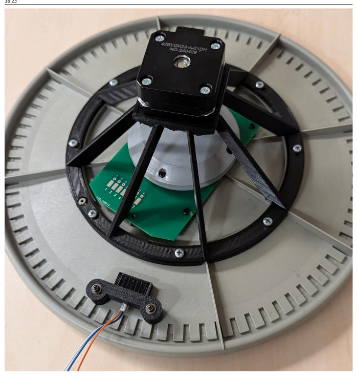
Am unteren Rand ist die Hallsensor-Halterung zu sehen - die passt genau auf die alten noch vorhandenen Befestigungsnippel
