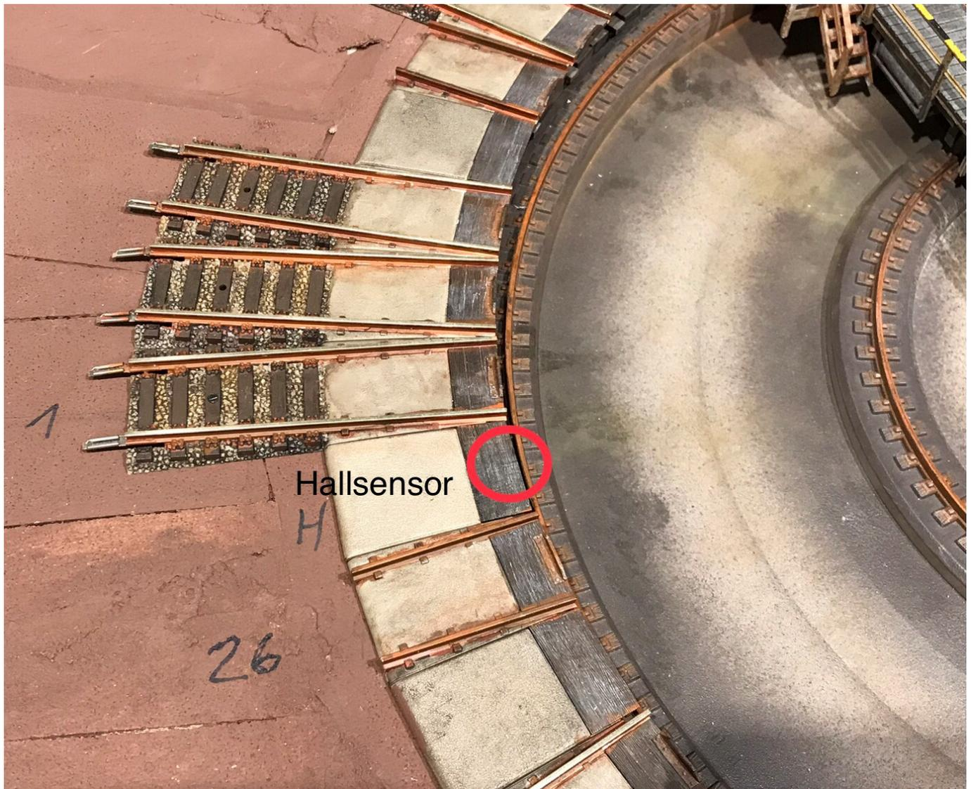
Für den Einbau des Hallsensors muss ein geeigneter Ort gefunden werden. Bei der Fleischmann-Drehscheibe bietet sich der Einbau in einem Randstück der Drehscheibe an, in das ein passendes Loch gebohrt werden muss. Die Höhe muss zum Magnetmontageort passen - Sensor und Magnet müssen fluchten.
