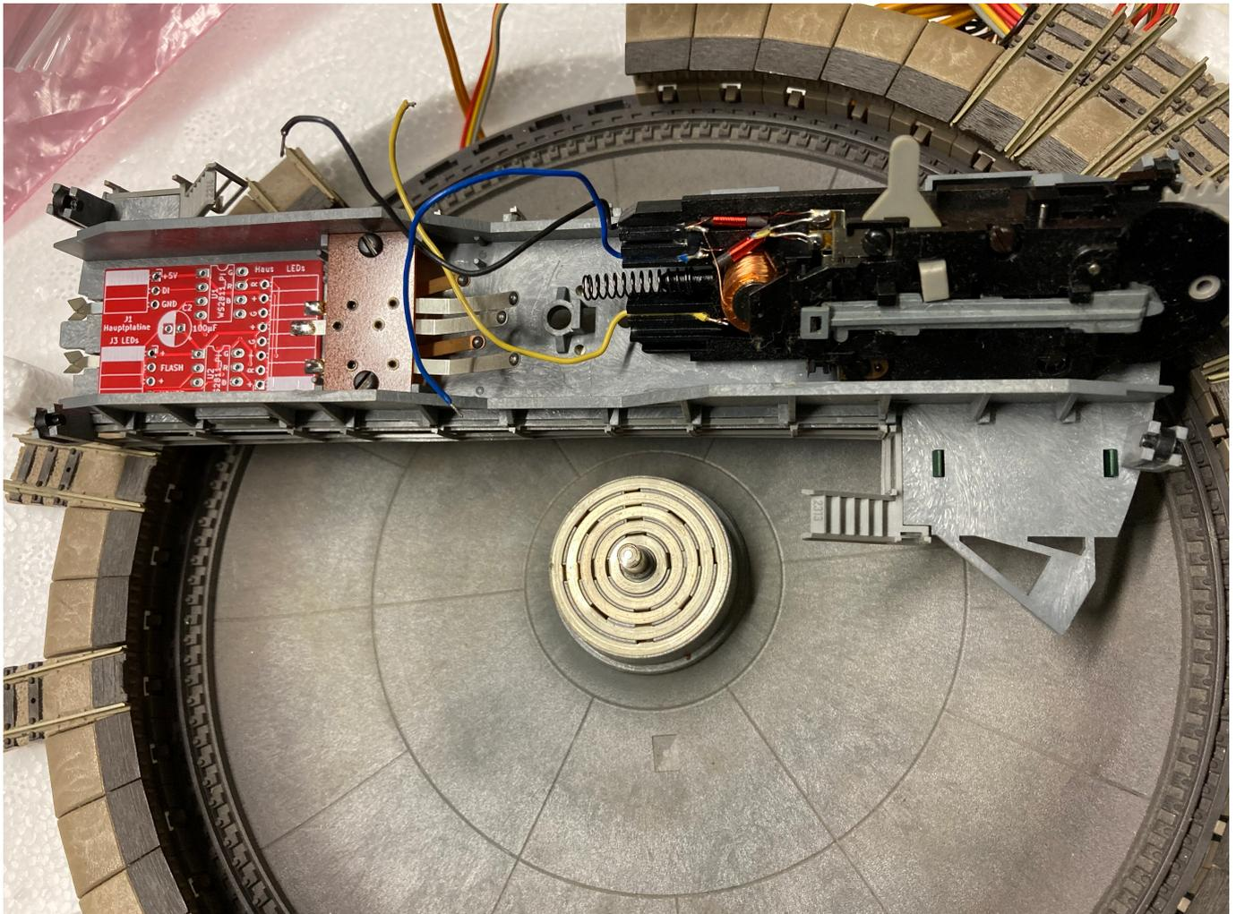
Die Motoreinheit muss natürlich noch entfernt werden 😊.
