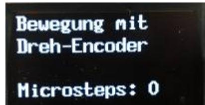
Das Feintuning, d.h. manuelles Anfahren eines Ports zur Feineinstellung, sollte über den Drehencoder durchgeführt werden und nur in Ausnahmefällen mit dem Poti.
