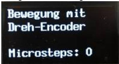
Das Feintuning, d.h. manuelles Anfahren eines Ports zur Feineinstellung, sollte über den Drehencoder durchgeführt werden und nur in Ausnahmefällen mit dem Poti.
