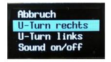
Ein **kurzer** Klick des Encoder-Buttons während die Drehscheibe steht, verzweigt in ein Menü, das auf dem OLED-Display angezeigt wird. Hier kann man durch Drehen des Encoders durch die Menüpunkte rauf- und runterscrollen.
