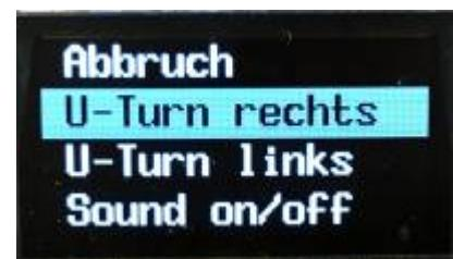
Ein **kurzer** Klick des Encoder-Buttons während die Drehscheibe steht, verzweigt in ein Menü, das auf dem OLED-Display angezeigt wird. Hier kann man durch Drehen des Encoders durch die Menüpunkte rauf- und runterscrollen.
