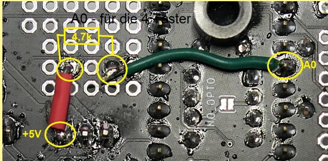
Alternativ kann man den 4,7k Widerstand auch auf der roten Panelplatine zwischen Pin 5 und Pin 10 des 10-poligen Wannensteckers von unten auflöten.
