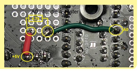
Alternativ kann man den 4,7k Widerstand auch auf der roten Panelplatine zwischen Pin 5 und Pin 10 des 10-poligen Wannensteckers von unten auflöten.
