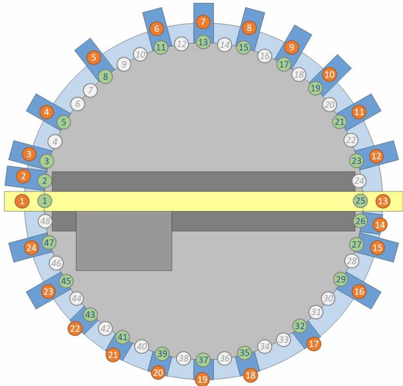
**2. Echte Drehscheiben nummerieren häufig alle Ports durch, auch inaktive Ports, an denen keine Gleise angeschlossen ist, erhalten eine Nummer. Die Drehscheibe hat demzufolge dann 1 - 48 Ports, von denen nur bestimmte Ports genutzt werden.**
