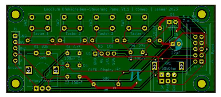
Hier ein Bild einer früheren Version der Panelplatine (mittlerweile wurden die beiden Kondensatoren am Drehencoder auf der Platine integriert):
