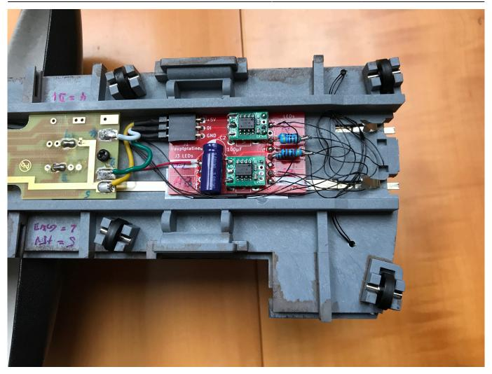
Im Bild sieht man auch 2 WS2811, die aus einer sogenannten Schokoladentafel stammen. Folgende WS2811 kamen zum Einsatz: Externer Link. Bei ihnen ist u.U. die RGB-Belegung vertauscht, der Footprint auf der Platine ist jedoch daran angepasst.
