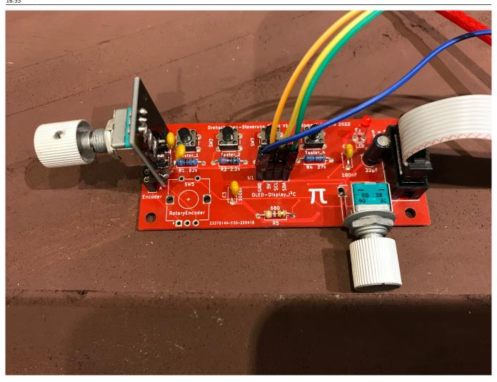
Beim finalen Einbau in die Modellbahnanlage werden Drehencoder, Poti, Taster und LED sowie das OLED über kurze Kabel verbunden.
