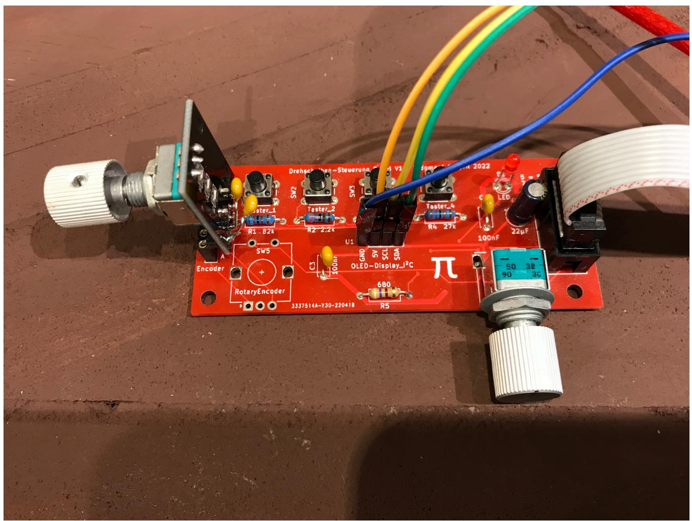
Beim finalen Einbau in die Modellbahnanlage werden Drehencoder, Poti, Taster und LED sowie das OLED über kurze Kabel verbunden.
