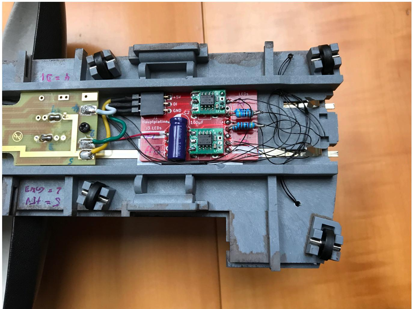
Im Bild sieht man auch 2 WS2811, die aus einer sogenannten Schokoladentafel stammen. Folgende WS2811 kamen zum Einsatz: [Externer Link](#). Bei ihnen ist u.U. die RGB-Belegung vertauscht, der Footprint auf der Platine ist jedoch daran angepasst.
